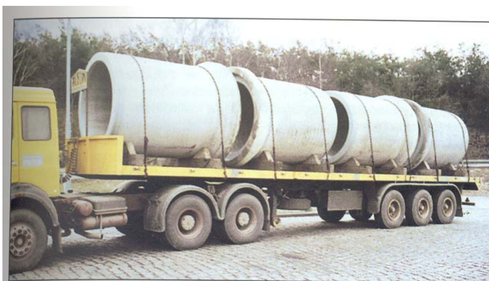
Abb. 50: Ein nach DIN 19 695 „Befördern und Lagern von Beton-, Stahlbeton- und Spannbetonrohren, zugehörigen Formstücken sowie Schachtringen“ beladenes Fahrzeug.
