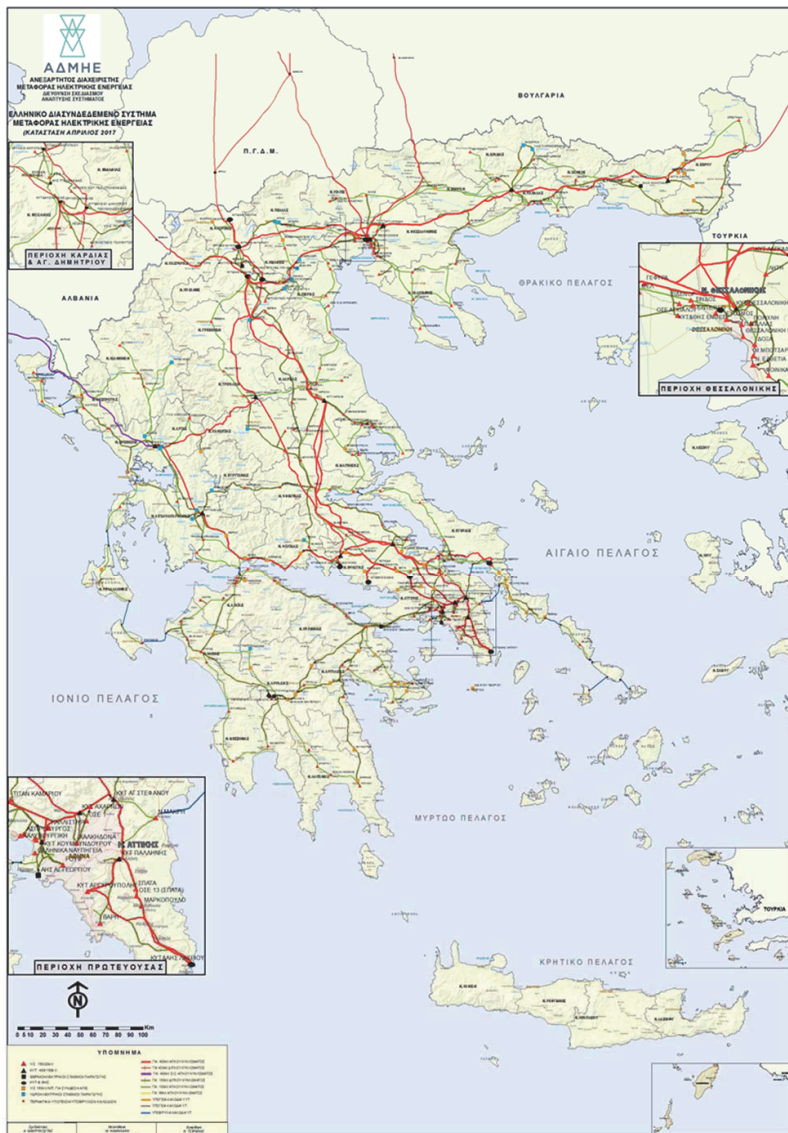
Εικόνα Α.1: Εθνικό διασυνδεδεμένο σύστημα ηλεκτρικής ενέργειας 19 .
