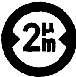
(P-21) Άπαγορεύεται η είσοδος εις όχήματα συνολικού πλάτους ύπερβαίνοντα τά ..... (π.χ.2) μέτρα.
