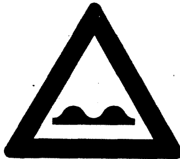
(K-9) Ἐπικινδύνως ἀνώμαλον ὁδόστρωμα, εἰς κακὴν κατάστασιν, μετὰ λάκων κλπ.
