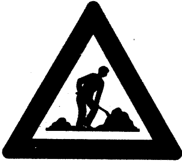
(K-20) Κίνδυνος λόγω εκτελουμένων εργασιών επί της οδού.
