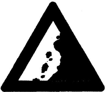
(K-14) Κίνδυνος ἐκ πτώσεως βράχων καὶ κατὰ συνέπειαν λόγφ τυχόν παρουσί- ας τῶν ἐπὶ τοῦ ὁδοστρώματος.
