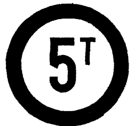
(P-23) Άπαγορεύεται η είσοδος εις όχήματα συνολικού βάρους ύπερβαίνοντα τούς ..... (π.χ. 5) τόννους.
