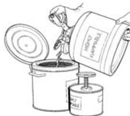
Εικ. 10: Δοχεία αποθήκευσης εύφλεκτων υγρών
