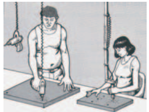
Εικ. 30. Ανάρτηση εργαλείων από το ταβάνι για να χρησιμοποιούνται σε άνετη στάση.
