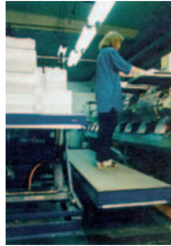
Εικ. 4 και 5. Προσαρμογή τόσο του ανυψωτικού τραπεζιού από το οποίο μεταφέρεται το χαρτί όσο και της πλατφόρμας πάνω στην οποία στέκεται η εργαζόμενη.
