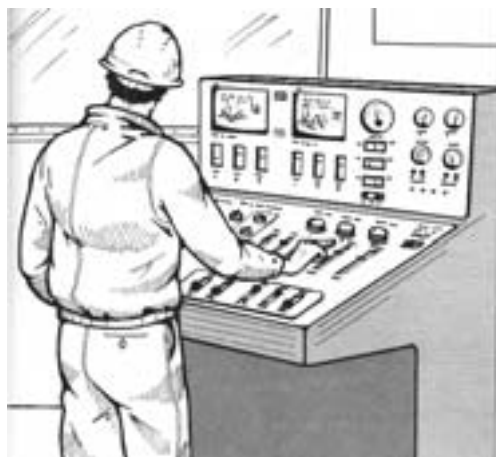
Εικ. 31. Ο εργαζόμενος πρέπει να φτάνει εύκολα διακόπτες, μοχλούς /λεβιέδες και πόμολα/λαβές από τη συνήθη θέση εργασίας
