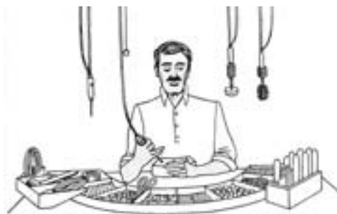
Εικ. 20. Τα υλικά και τα εργαλεία που χρησιμοποιούνται συχνά πρέπει να είναι κοντά στο σώμα.
