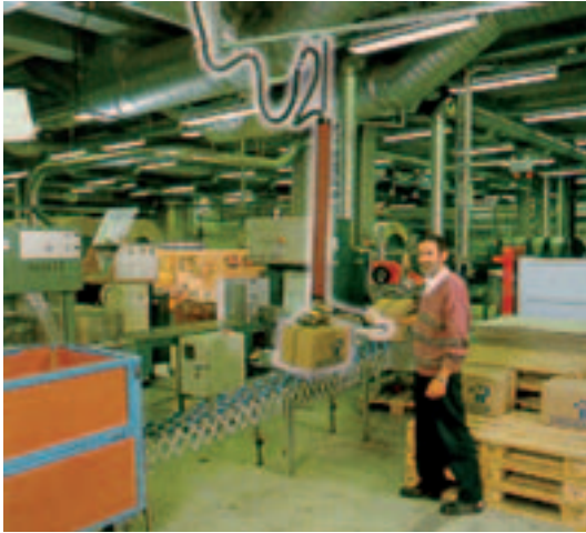
Εικ. 2. Μια αντλία κενού αναρτημένη από το ταβάνι μεταφέρει το χαρτοκιβώτιο από την ταινία μεταφοράς στην παλέτα.
