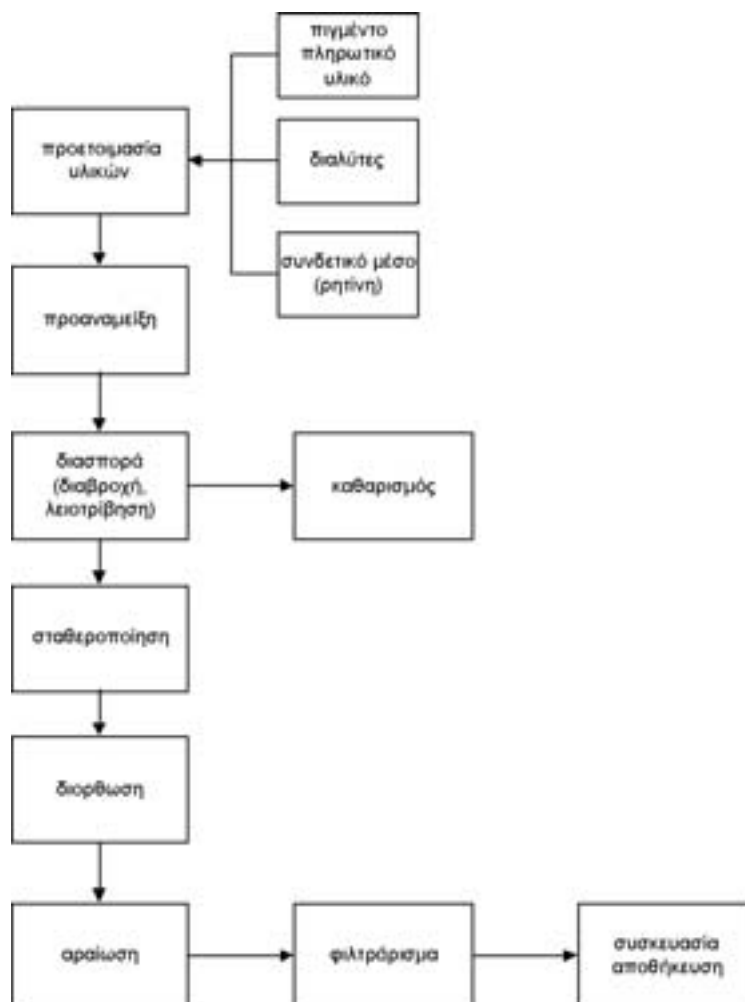
Διάγραμμα [2.2.6] 1: Τυπικό διάγραμμα ροής για την παραγωγή χρωμάτων [τροποποιημένο από την πηγή 9]
