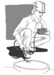
Εικόνα 26: Έλεγχος της ατμόσφαιρας με κατάλληλο εξοπλισμό.
