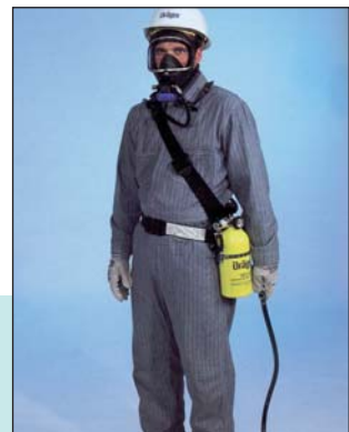
Εικόνα 15: Εργαζόμενος με μάσκα, όπου η παροχή αναπνεύσιμου αέρα γίνεται με σωλήνα από εξωτερική πηγή σε απόσταση (SAR).
