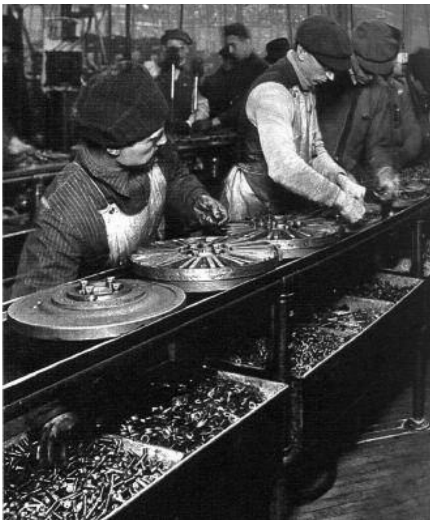
Εικόνα 2: Αλυσίδα συναρμολόγησης σφονδύλων στην αυτοκινητοβιομηχανία του Henry Ford στο Detroit. Την αρχή της μαζικής παραγωγής με αλυσίδα συναρμολόγησης υιοθέτησε ο Ford από τα σφαγεία του Σικάγου.
