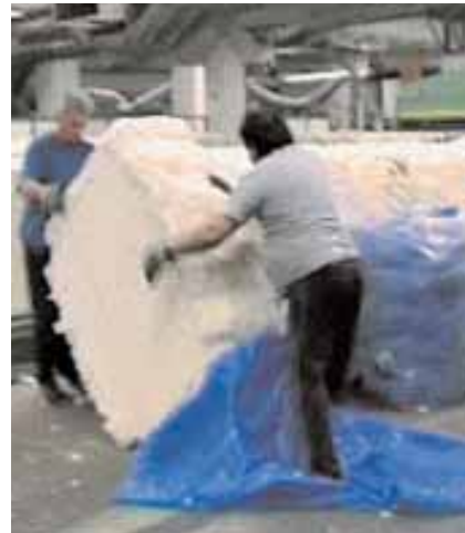
Εικ. 13. Τροφοδότηση ανοικτικού μηχανήματος. Πηγή: 20
