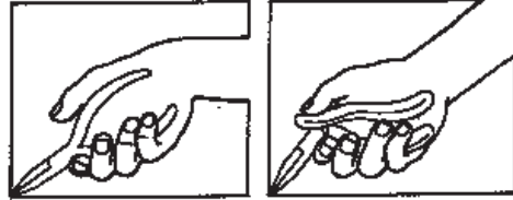
Εικ. 29. Επανασχεδιάστε τα εργαλεία ώστε να κάμπτεται το εργαλείο και όχι ο καρπός. Πηγή: 3
