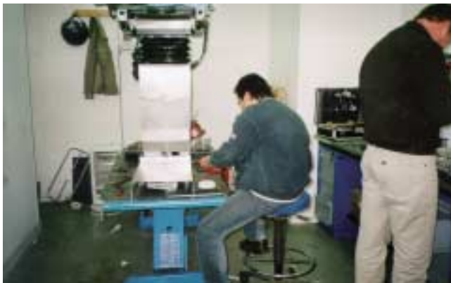
1ος εργαζόμενος(αριστερά): Συναρμολόγηση του κάτω μέρους χειρουργικού τραπεζιού – Κίνδυνος πτώσης τμήματος μηχανήματος, λανθασμένη στάση του κορμού και των άκρων του εργαζόμενου.
