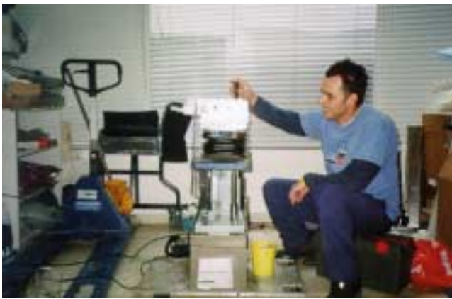
Επισκευή τμήματος χειρουργικού τραπεζιού – Έλλειψη εργονομικού καθίσματος εργασίας και ύπαρξη εμποδίων (εξαρτήματα, μέρη μηχανημάτων, ανταλλακτικά) στο χώρο εργασίας.
