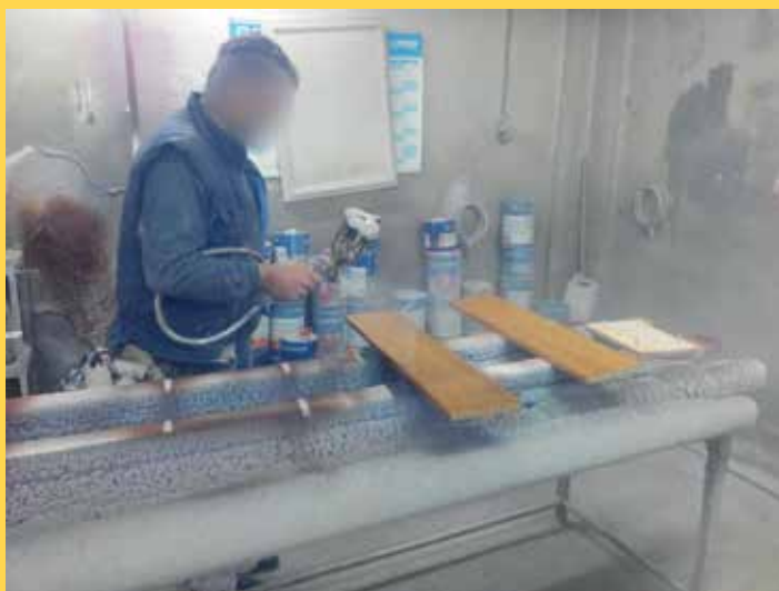
Εργασία βαφής χωρίς μέσα ατομικής προστασίας
