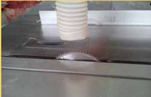
Εκ των υστέρων αφαίρεση προφυλακτήρα σε πιστοποιημένη γωνιάστρα
