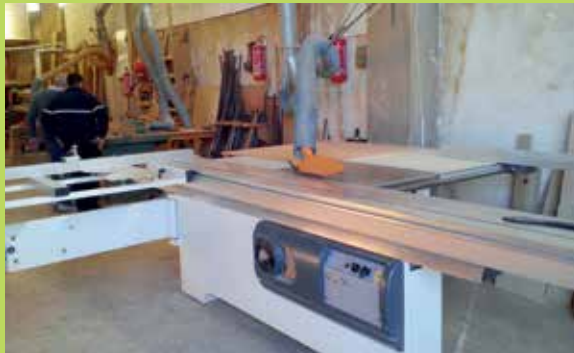
Σύστημα αναρρόφησης σκόνης ξύλου σε γωνιάστρα
