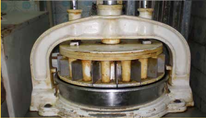
Μηχάνημα κοπής χωρίς προστατευτικό
