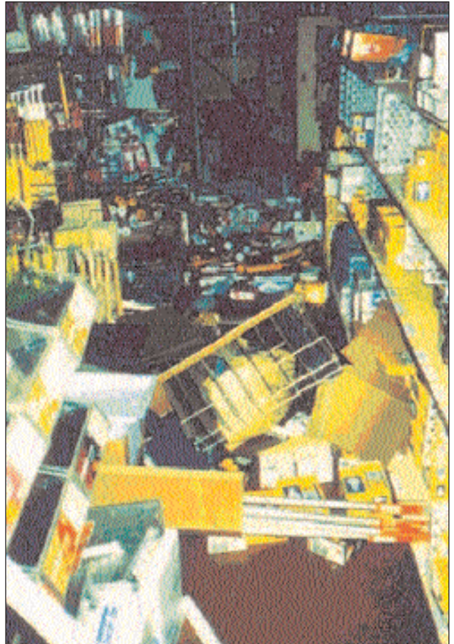
Σχήμα 36. Ανατροπή αρχειοθήκης και διασκορπισμός περιεχομένου ραφιών.
