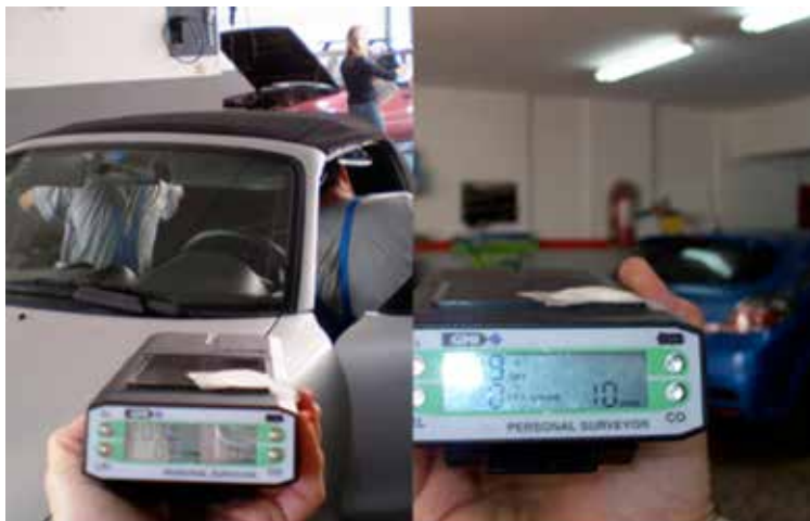
Εικόνα 23: Προσδιορισμός καυσαερίων στα συνεργεία αυτοκινήτων
