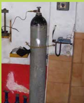
Εικόνα 10: Στερέωση φιάλης έναντι πτώσης
