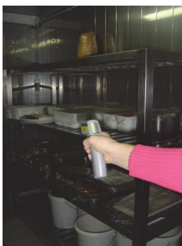
Εικόνα 30:Θερμομέτρηση ψυκτικού θαλάμου
