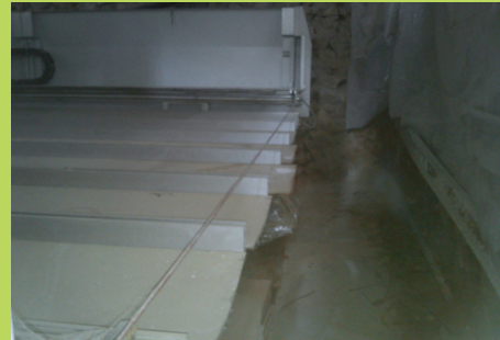
Συρματόσχοινο ασφαλείας για την παρεμπόδιση πρόσβασης στο πίσω μέρος του μηχανήματος
