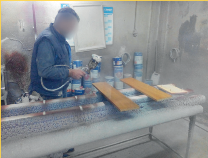
Εργασία βαφής χωρίς μέσα ατομικής προστασίας
