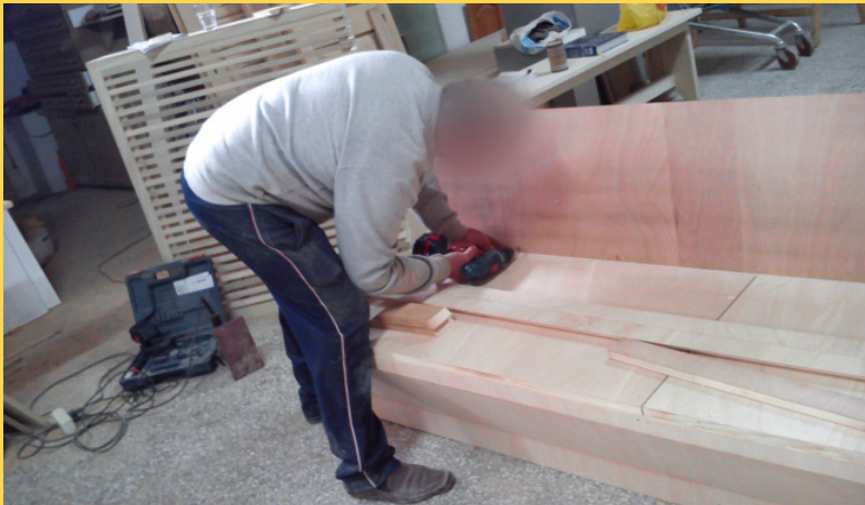
Επίπνες στάσεις εργασίας (επίκουψη/πλάγια κάμψη κορμού και απαγωγή βραχιόνων) κατά τη συναρμολόγηση επίπλου
