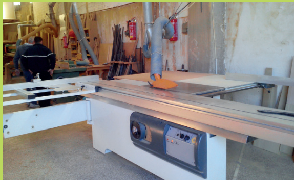
Σύστημα αναρρόφησης σκόνης ξύλου σε γωνιάστρα
